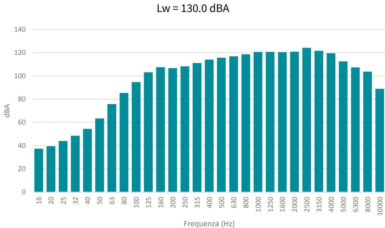
Fig. 4 Spettro della potenza sonora – Terzi d’ottava
