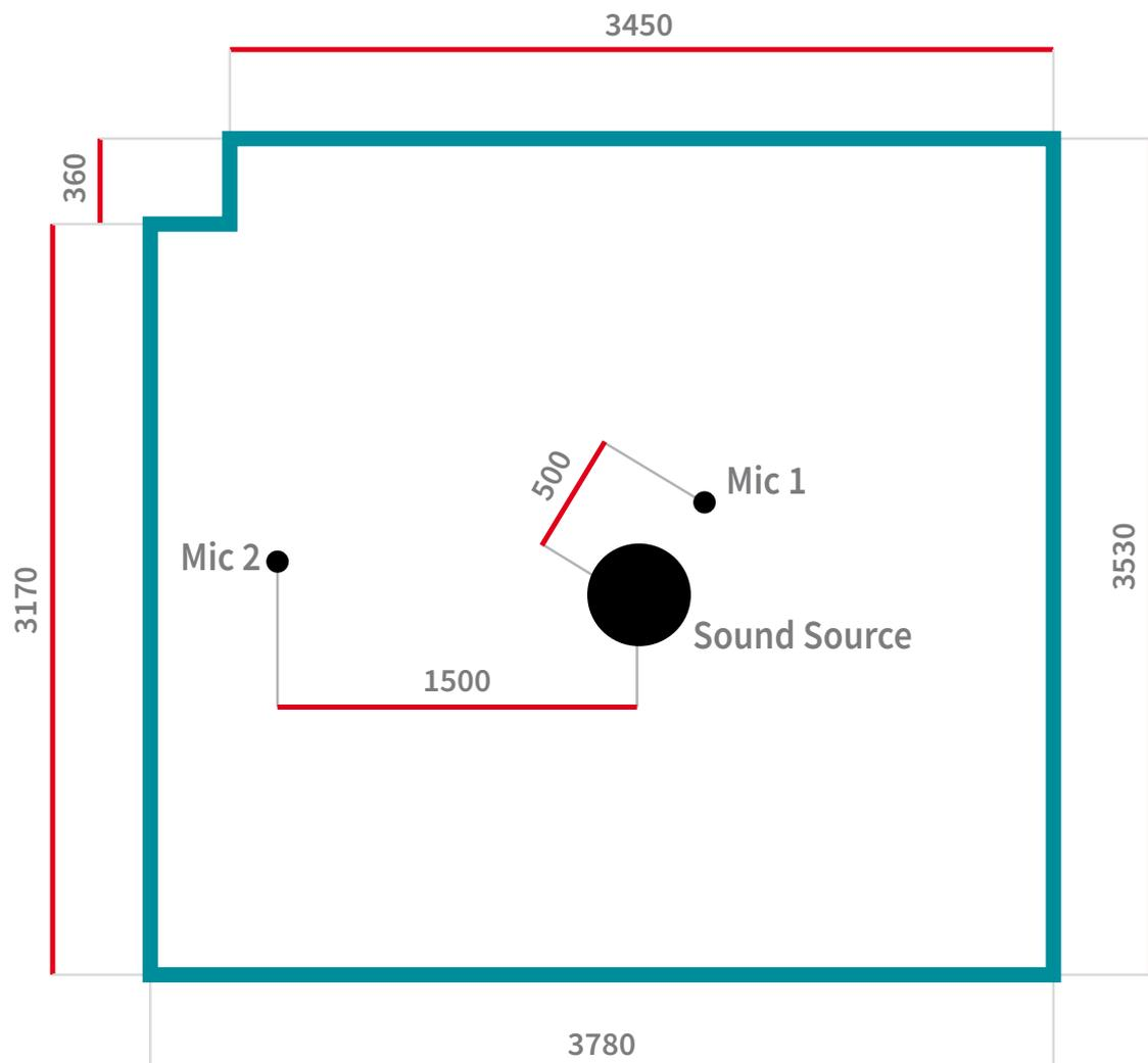
Fig. 2 Posizione dei microfoni – Mic 1 serve per la misurazione della potenza sonora, mentre Mic 2 è per quella della pressione sonora. Le distanze sono espresse in mm
