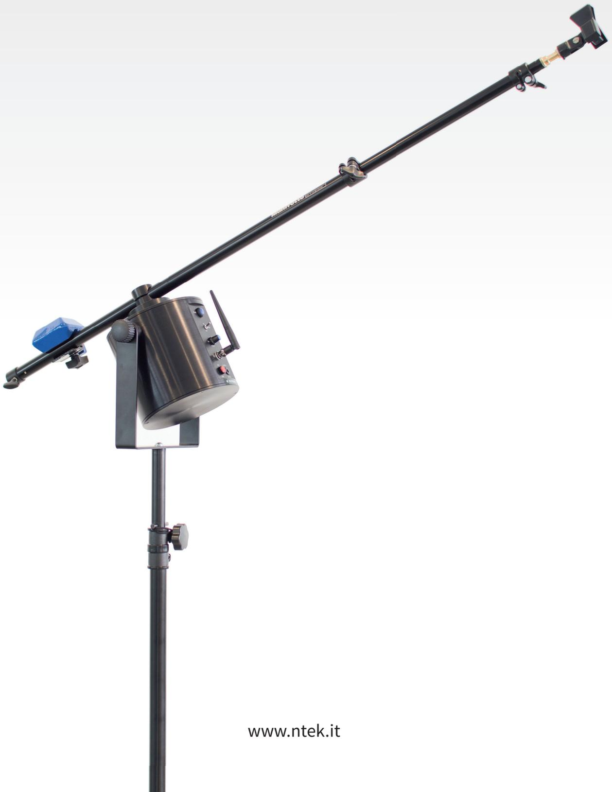
L'asta microfonica rotante MB01 viene utilizzata per ottenere la misurazione spaziale dei livelli di pressione sonora spostando avanti ed indietro il microfono continuamente. La velocità di rotazione, l'angolo e la lunghezza del braccio sono regolabili.
