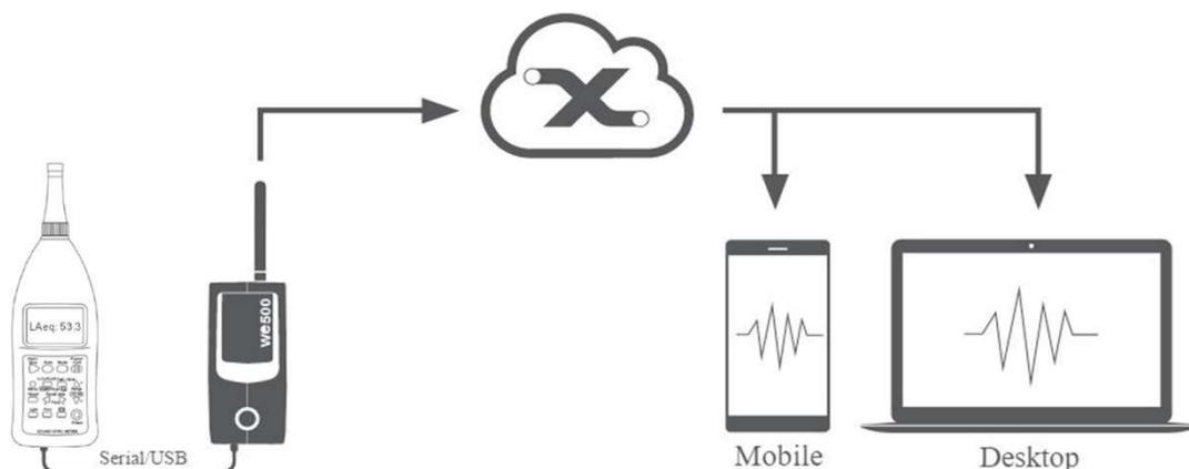
La **centralina di monitoraggio acustico** Ntek è uno strumento indispensabile per la verifica, in tempo reale, del rispetto dei limiti consentiti per le emissioni sonore. Uno strumento pratico, che non richiede alcun tipo di intervento umano in loco dopo l'installazione ed il set-up. Non necessita di software perché la pubblicazione delle misure effettuate e delle statistiche avvengono direttamente sul Cloud attraverso un'interfaccia intuitiva.
