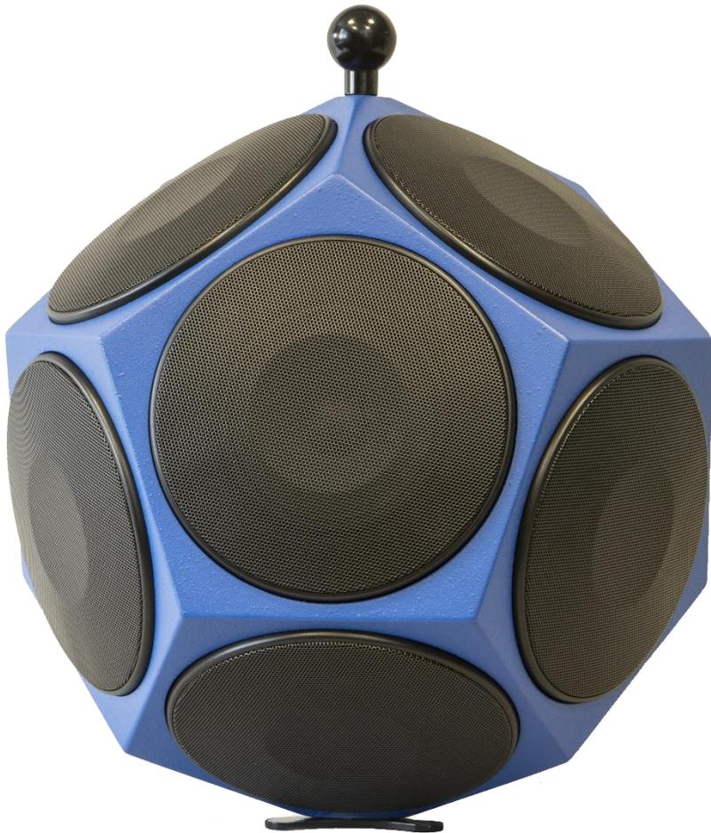
La sorgente sonora omnidirezionale OMNI 5'' è la soluzione dal design tradizionale che irradia il suono in modo isotropico per ottenere un campo sonoro coerente ad ogni angolo. OMNI 5'' consente misurazioni attendibili di isolamento e tempo di riverbero, anche in ambienti di prova di grandi dimensioni.
